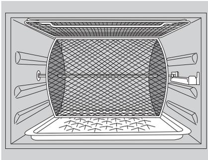
メッシュバスケットにロティサリーバーを差し込みバーの**片側**を留めネジで固定してください。
