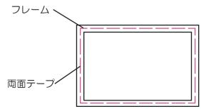
フレーハ幅 外形寸法(幅×高さ) 誤差 ± 1 誤差 ±0.2 32 インチ 7406x4338 87 43 インチ 971 2x564 1 8.7 95 55 インチ 1248.5x722.9 65 インチ 1472.2x846.8 9.5 95 75 インチ 1690.5x970.7
